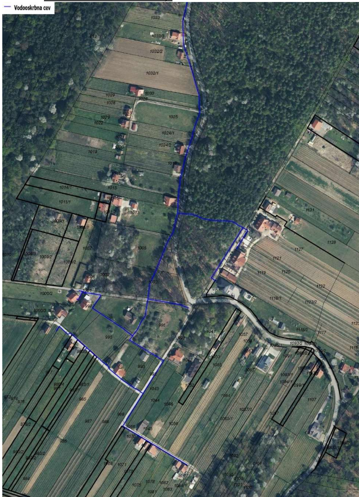
Slika 5: obstoječa vodovodna kanalizacija, vir: https://gis.iobcina.si , januar 2023
